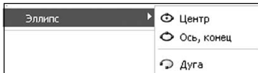
Рис. 3.23. Способы построения эллипса и эллиптической дуги
