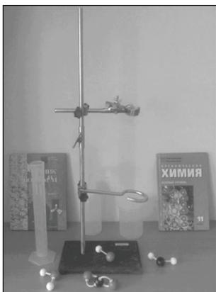
9. Укрепите пробирку в лапке в вертикальном положении отверстием вверх.
