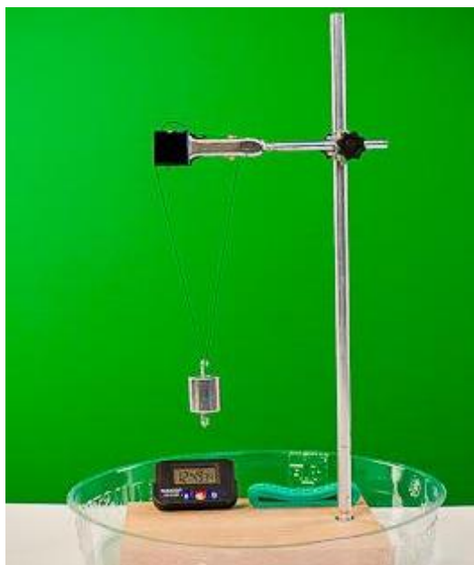
Рис.15 Установка L – мікро для исследования свойств математического маятника
