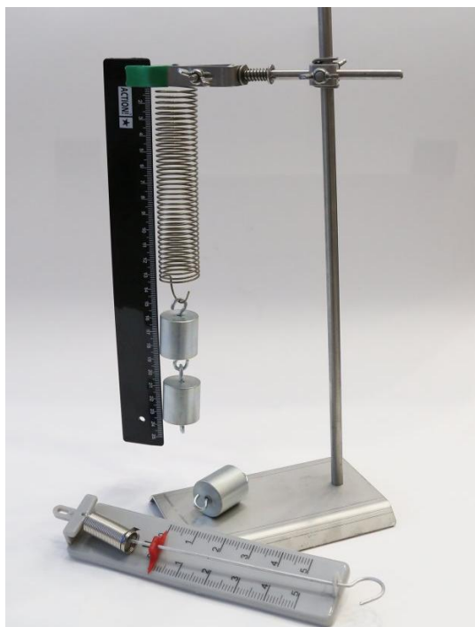
Рис. 26 Изучение упругих свойств пружины
