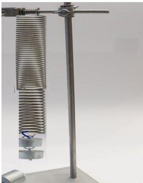
Рис. 28 Исследование упругих свойств последовательно соединенных пружин.
