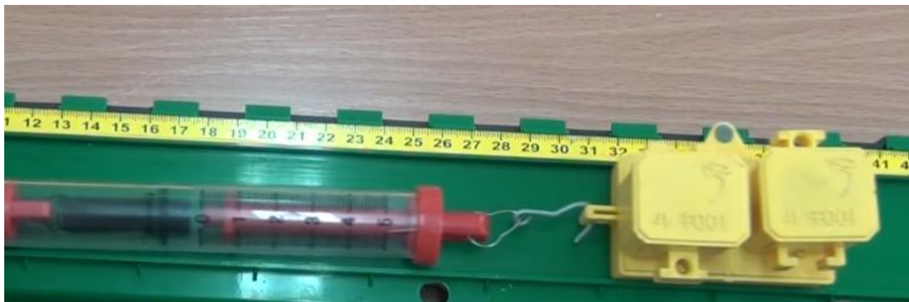
Рис.19. Установка комплекта №2 L – micro, ОГЭ, Физика, реализующая выполнение лабораторной работы по измерению коэффициента трения скольжения.
