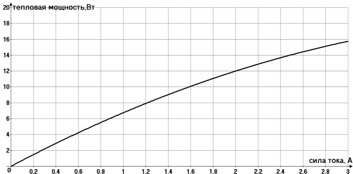
Рис. 48. Теоретический график зависимости P_R(I) (Advanced Grapher) для \varepsilon = 7.5\text{В} и r = 0.75\text{ Ом} комплекта №3 ГИА –лаборатории.
