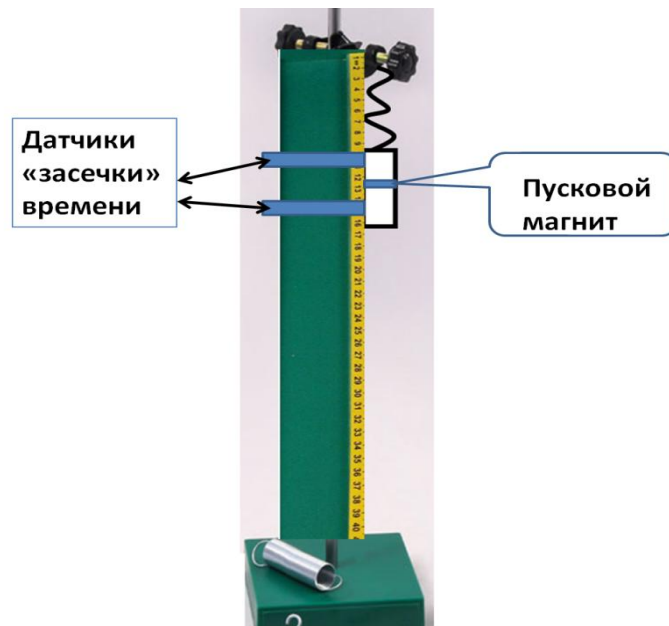
Рис.9 Измерение амплитуды скорости для колебания груза на пружине.
